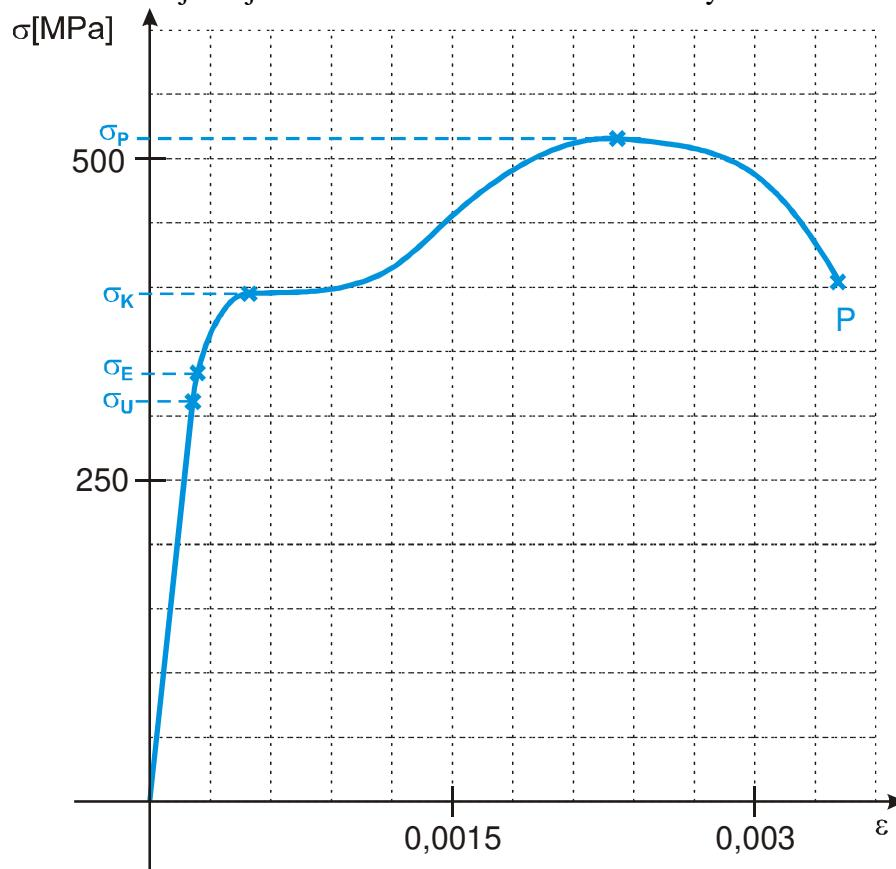
Pro hodnoty normálového napětí menší než  $\sigma_u$  je normálové napětí přímo úměrné relativnímu prodloužení:  $\sigma = K \cdot \varepsilon \Rightarrow$  **Hookův zákon** (konstanta úměrnosti se značí  $E$ ):
